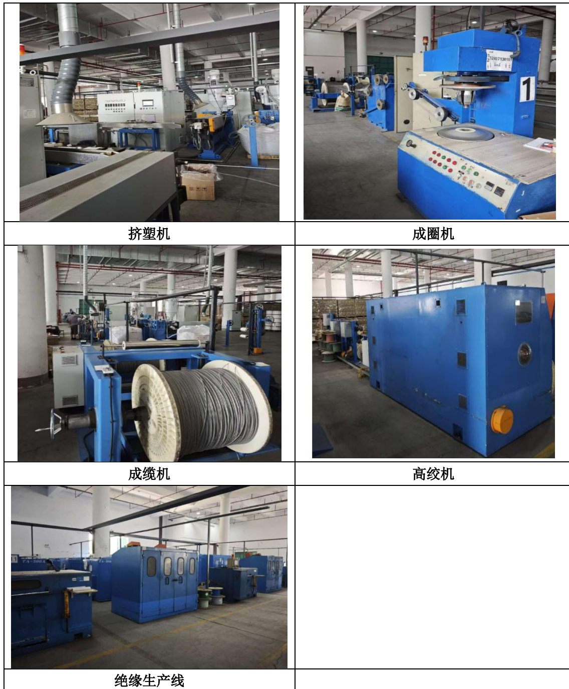
图 2-1 本项目设备照片
