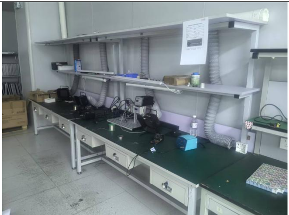
焊接废气收集
